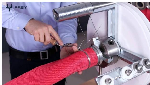
Ist ein erneutes Einbinden eines Schlauches erforderlich (z. B. nach Kürzung) wird zuerst an der Schadstelle sauber und rechtwinklig abgeschnitten.
