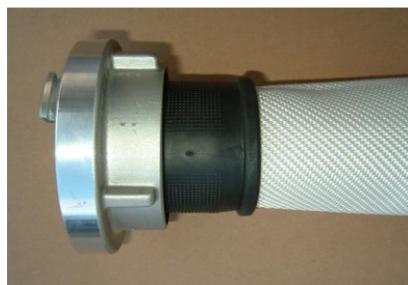
Alle Druckschläuche der Leistungsstufen L2 und L3 sind mit einem sogenannten Schlag- und Scheuerschutz auszurüsten, der das Schlauchgewebe am Ende des Einbindestutzens schützt. Dieser Schlag- und Scheuerschutz, zum Beispiel eine **Manschette aus einem geeigneten Gummiwerkstoff** mit einer ausreichenden Wandstärke, reicht von der Kupplung bis ca. 10 mm über das Ende des Einbindestutzens hinaus.
